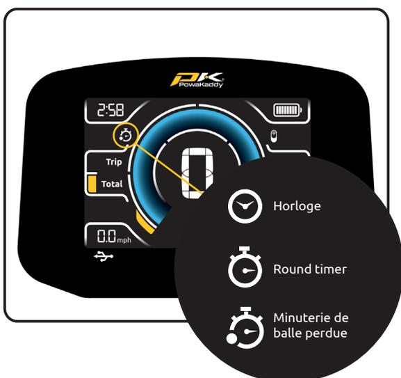
**Bouton de fonction gauche :** appuyez pour basculer entre l'horloge, la minuterie du temps de parcours et la minuterie de balle perdue.
